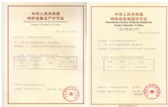
右图为原特种设备制造许可证，左图为新特种设备生产许可证。新特种设备生产许可证许可子项目栏中增加压力管道管子（B）项目，许可参数为公称压力小于 10MPa，即可覆盖生产以上公称压力内的所有无缝钢管。
