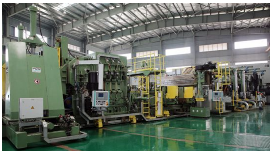
具有国际领先水平的预精焊螺旋管生产线
